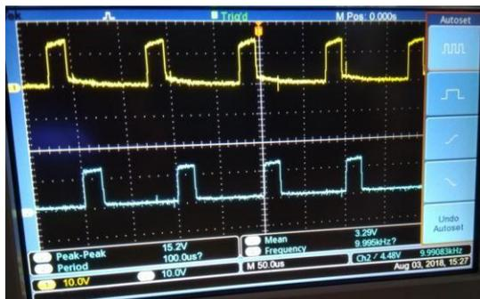
Gambar 10. Data TLP250 dengan beban mosfet pada rangkaian buck-boost converter
